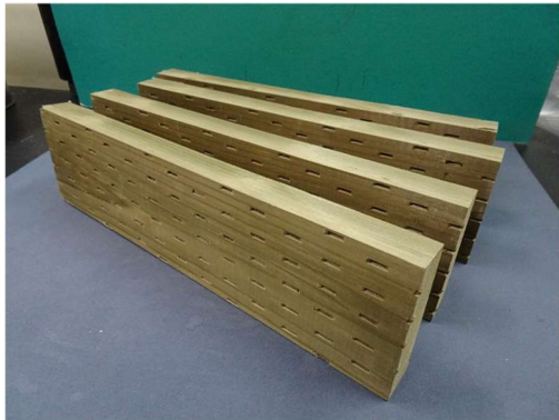
写真 3.1 加圧注入処理を行った試験材料の例（左：製材，右：合板）
