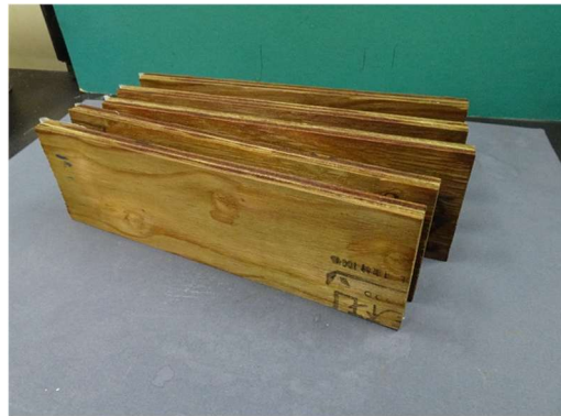
写真 3.1 加圧注入処理を行った試験材料の例（左：製材，右：合板）
