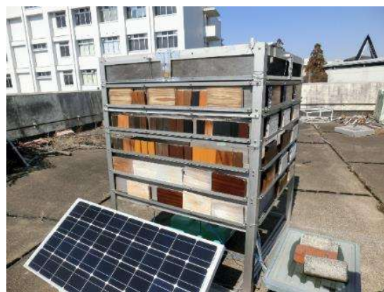
写真 2.7-2 四面暴露架台と暴露試験
