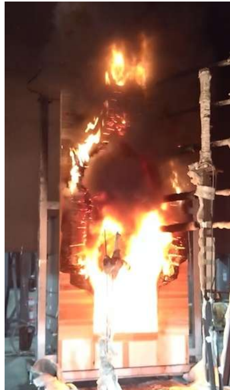
写真 2.3-4 ファサード試験 加熱中の様子 (約 9 分経過時) (試験体 N(9))
