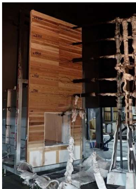
写真 2.3-1 ファサード試験装置外観 (試験体 N(9))
