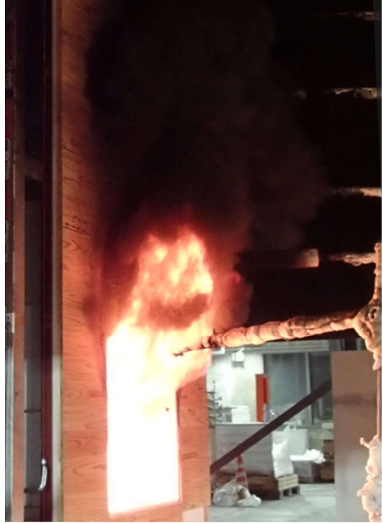
写真 2.3-2 ファサード試験 加熱中の様子 (約 2 分経過時) (左：試験体 B R 、右：試験体 C)
