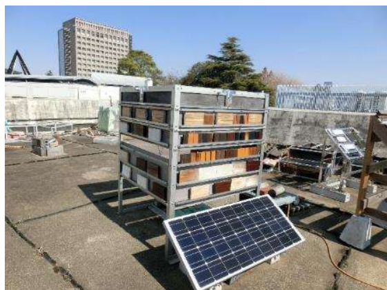
写真 2.7-2 四面暴露架台と暴露試験
