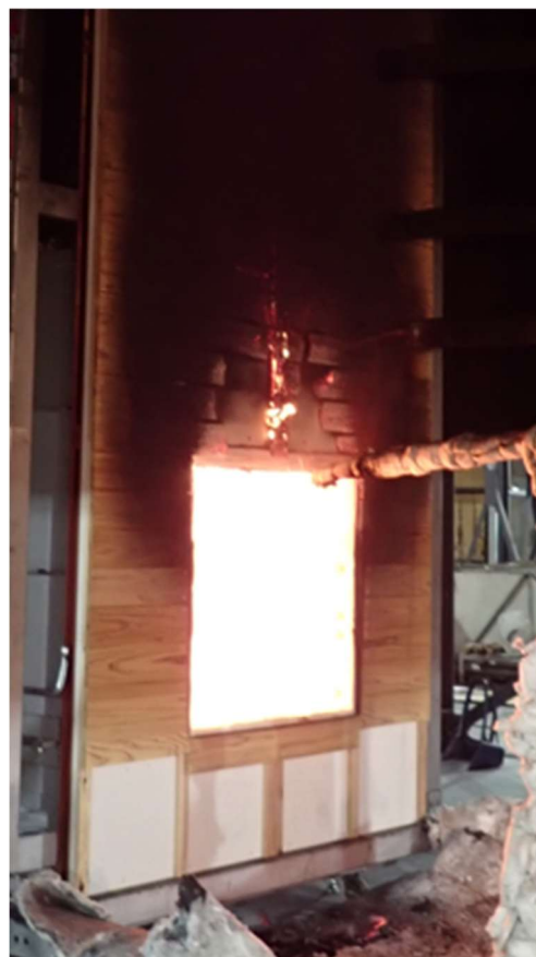
写真 2.3-5 ファサード試験 加熱終了時（左：試験体 B R 、右：試験体 C）
