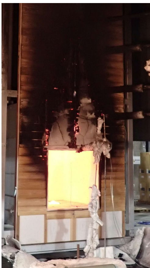
写真 2.3-5 ファサード試験 加熱終了時（左：試験体 B R 、右：試験体 C）
