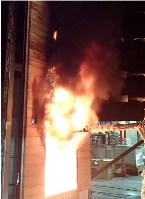
写真 2.3-2 ファサード試験 加熱中の様子 (約 2 分経過時) (左：試験体 B R 、右：試験体 C)
