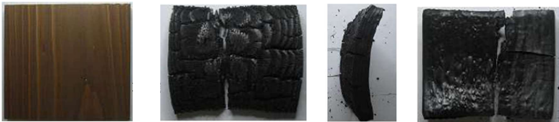
写真 2.5-2 試験体 A の試験前後の状況例 (左から試験前、試験後正面、側辺、裏面)
