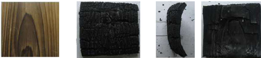
写真 2.5-3 試験体 B s の試験前後の状況例 (左から試験前、試験後正面、側辺、裏面)
